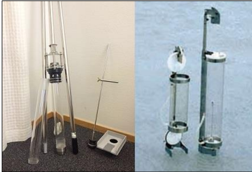
Figur 2. Sedimentprovtagare KC typ B och Limnos vattenhämtare
