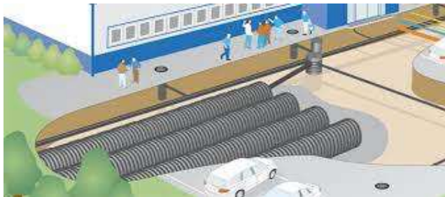
Figur 18. Principskiss för plaströrmagasin
